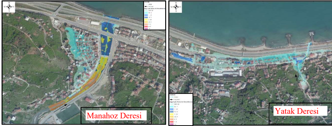
Şekil 2.50: Manahoz Deresi-Yatak Deresi Risk Alanı Q1000 Taşkın Alanı Haritası. (DSİ 22. Bölge Müdürlüğü, 2021)
